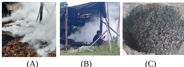
Gambar 3. Proses Pembakaran tempurung kelapa sampai menjadi arang Batok
