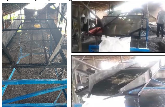
Gambar 6. Ayakan mekanis vibrator dan proses demonstrasi dengan Tim Pelaksana
