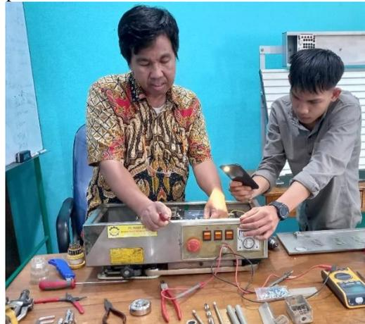
**Gambar 7** Perbaikan *Continuous Sealer Machine*
