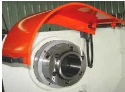
**Gambar 4.** Kepala tetap,tampak spindle utama mesin
