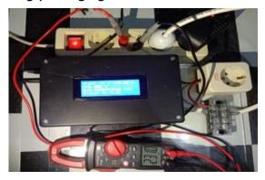
**Gambar 5**. Pengujian sensor tegangan
