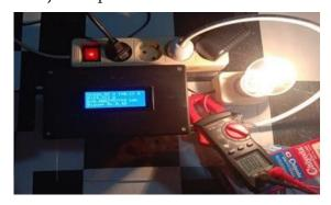
Gambar 4. Pengujian sensor arus ACS712
